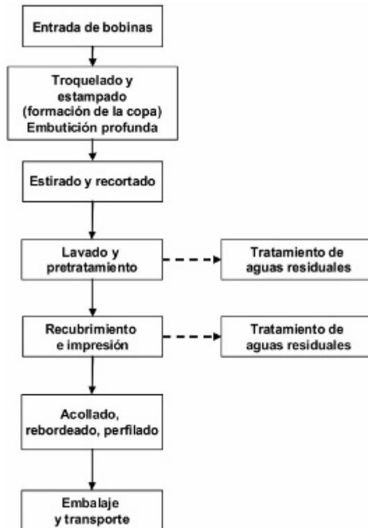
La descripción genérica siguiente abarca la fabricación de latas para bebidas, las cuales generalmente llevan un diseño impreso en el exterior, y de latas para comida, que están generalmente terminadas con un recubrimiento externo transparente incoloro y sin impresión. La totalidad del proceso, incluyendo el traslado entre las distintas fases, está totalmente automatizado.
